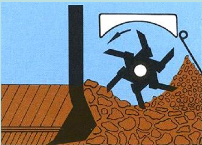
Rotační kypřič vodorovná osa rotace
