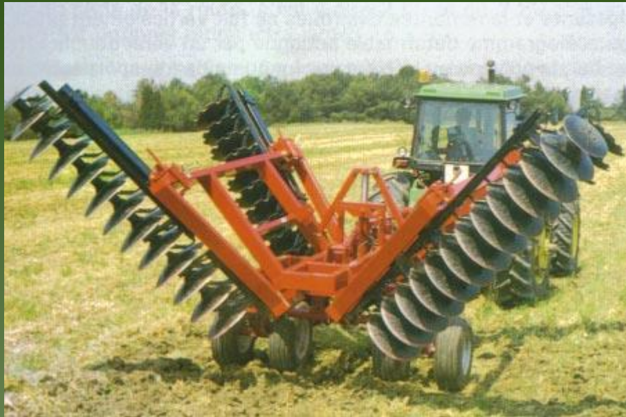
Disky jsou umístěny na hřídeli
